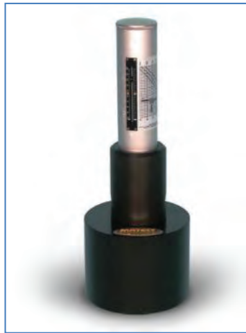
รูปที่ 4 แสดงตัวอย่างทังทดสอบ (Test Anvil)
