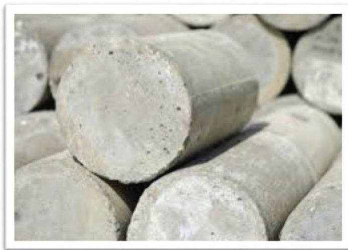
รูปที่ 7 แสดงตัวอย่างตัวอย่างทดสอบคอนกรีตทรงกระบอก ขนาดเส้นผ่านศูนย์กลาง 150 มิลลิเมตร สูง 300 มิลลิเมตร
