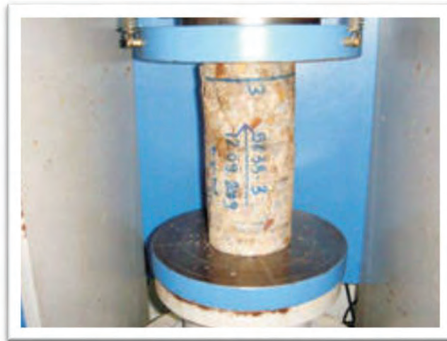
รูปที่ 8 แสดงตัวอย่างการทดสอบค่ากำลังอัดของก้อนตัวอย่างคอนกรีต โดยใช้เครื่องทดสอบกำลังอัด
